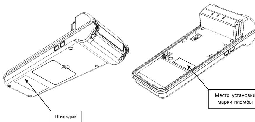
Марка-пломба устанавливается на винт крепления верхней части корпуса к его нижней части согласно рисунку. Шильдик наклеивается на кожух, закрывающий блок управления.
