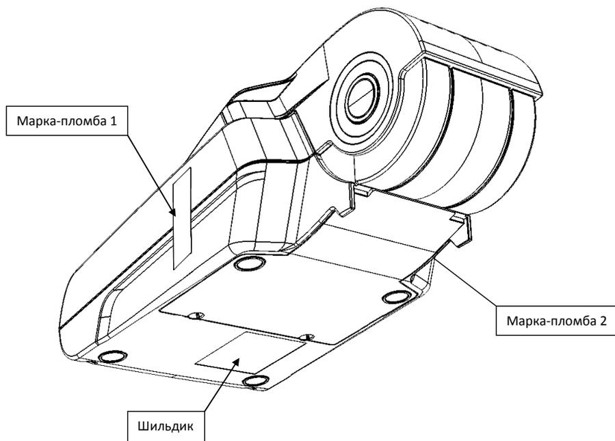
Два элемента марки-пломбы наклеивается с двух сторон на кожух, закрывающий блок управления и устройства печати кассовых чеков так, чтобы было невозможно получить доступ к внутренней части ККТ без разрушения марки-пломбы. Шильдик наклеивается на дно корпуса ККТ.
